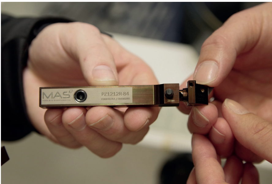
Bild 1: Sorgt für minimale Rüstzeiten: Das Schnellwechselsystem PZ©turn besteht aus dem quadratischen Halter mit Polygonaufnahme (links) und dem schnell wechselbaren Schneidkopf mit aufgeschraubter Schneidplatte
