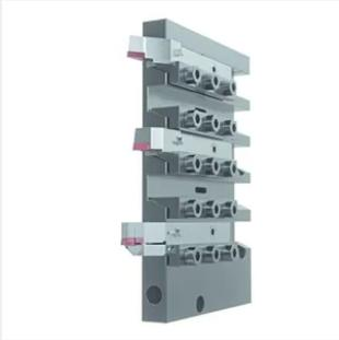
Damit sorgen die Aufspannplatten für äusserst prozesssicheres Drehen. Zudem ermöglichen sie minimale Rüstzeiten. Pro Auftragslos ist nur eine Aufspannplatte mit den voreingestellten Werkzeugen zu wechseln. Ein Ab- und Aufspannen sowie Justieren zahlreicher Werkzeuge im (kleinen) Arbeitsraum der Langdrehautomaten entfällt. Die schnell wechselbaren Aufspannplatten stehen für sämtliche üblichen Werkzeuge mit Quadratschaft zur Verfügung.
